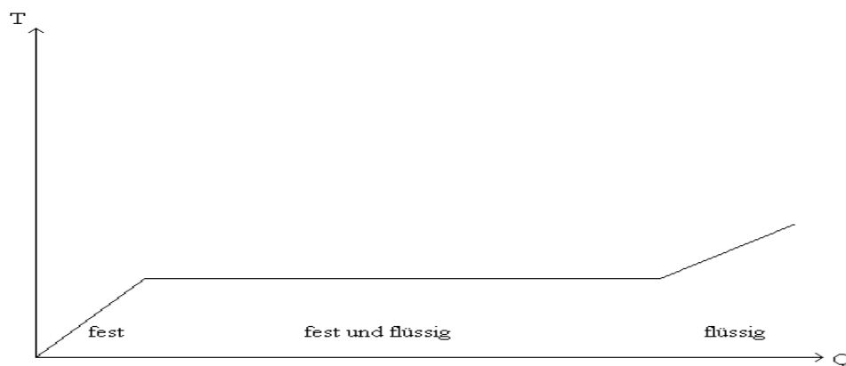
Abb. 6: Zur physikalischen Wirkungsweise der Schmelzkühlung: Typisches Schmelzdiagramm ( Q steht für die Wärmemenge, T für die Temperatur).
